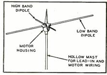
Fig. 17. Motor-driven antenna.
